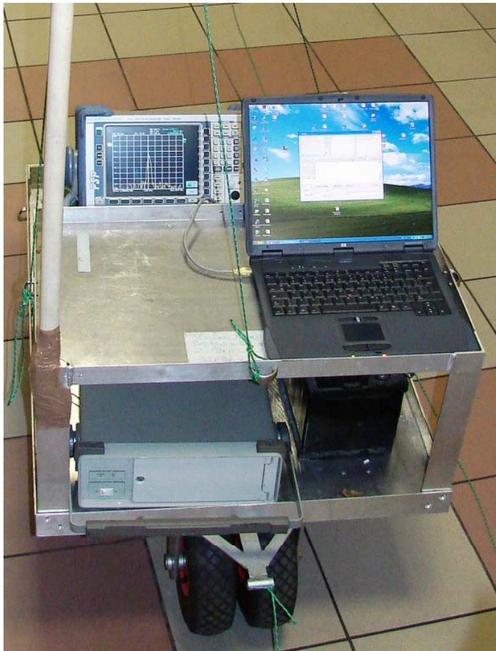
Układy pomiarowe wykorzystane do pomiarów pól we wnętrzach budynków
